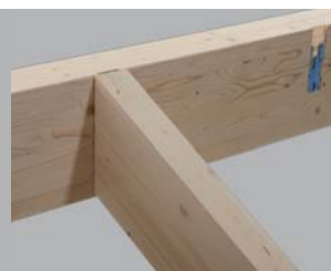
Vertikal nach unten geneigter Anschluss Haupt-/Nebenträger
